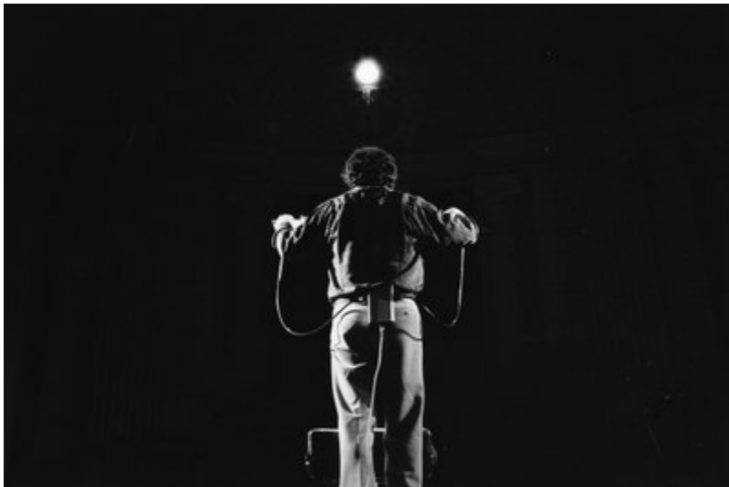
Michel Waisvisz mit The Hands , am Gürtel das "STEIM SensorLab", in dem die Sensordaten gewandelt werden und per MIDI Kabel zum Klangerzeuger gelangen. Bildquelle: STEIM Archiv.
